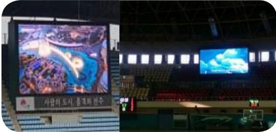
영상(8bit) 및 환경제어(4bit)를 동시에 처리하고 세부적인 제어방법으로 전송효율 우수하고 송수신 시스템을 하나로 적용하여 내부배선의 최적화로 관리 비용절감 효과가 우수. 하나의 메인컨트롤러로 여러 개의 영상 멀티 표출하여 제작 비용 절감효과우수. LED 모듈, 온도 습도 센서모듈, 냉각팬 모듈 이상 여부를 진단 검출결과를 사전에 인지하여 고장률을 미리 차단하여 수명 연장 우수
